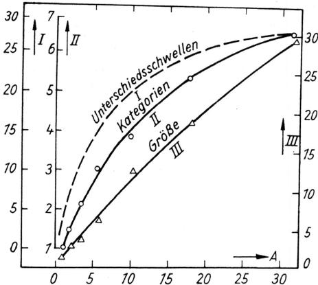
Abb. 2: Die Beziehungen zwischen Diskriminationskala (I), Kategorie-Schätzkala (II) und Größenschätzkala (III) für Vibrationsintensitäten der Amplitude A in willkürlichen Einheiten.
